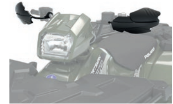
2876846 Protetor de mão Para instalação é necessário também o 2879380 SPORTSMAN 570 E NOVO SPORTSMAN 570
